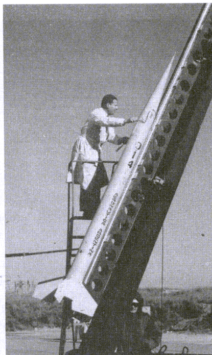
El cohete Orión fue uno de una serie de cohetes suborbitales de sondeo desarrollados por la Fuerza Aérea argentina para realizar experimentos científicos desde las bases de lanzamiento de la Antártida.
