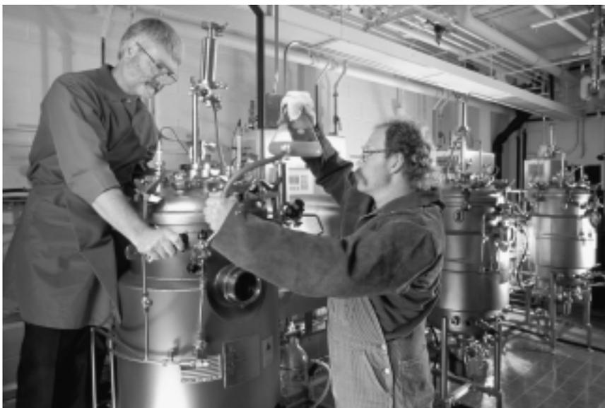
*En una escena salida de una película de H.G. Wells, un microbiólogo y su ayudante le agregan microorganismos a biorreactores piloto en los que se cocina el etanol a partir de una mezcla de azúcares derivada de la fibra del maíz. El sueño es que destilerías de etanol salpiquen los campos, explotando la mano de obra de campesinos muy trabajadores en un radio de 40 a 50 km para las plantas que usen maíz como insumo, y de 95 para las que usen pasto varilla. (Foto: Keith Weller/USDA).*
