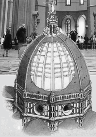
Filippo Brunelleschi introdujo el principio físico de la catenaria en la construcción de la gran cúpula de la catedral de Florencia. El corte transversal en la cúpula muestra la estructura interna. (Fotos: Ricardo André Frantz [izq.]; cortesía de Pennie Sabel).
